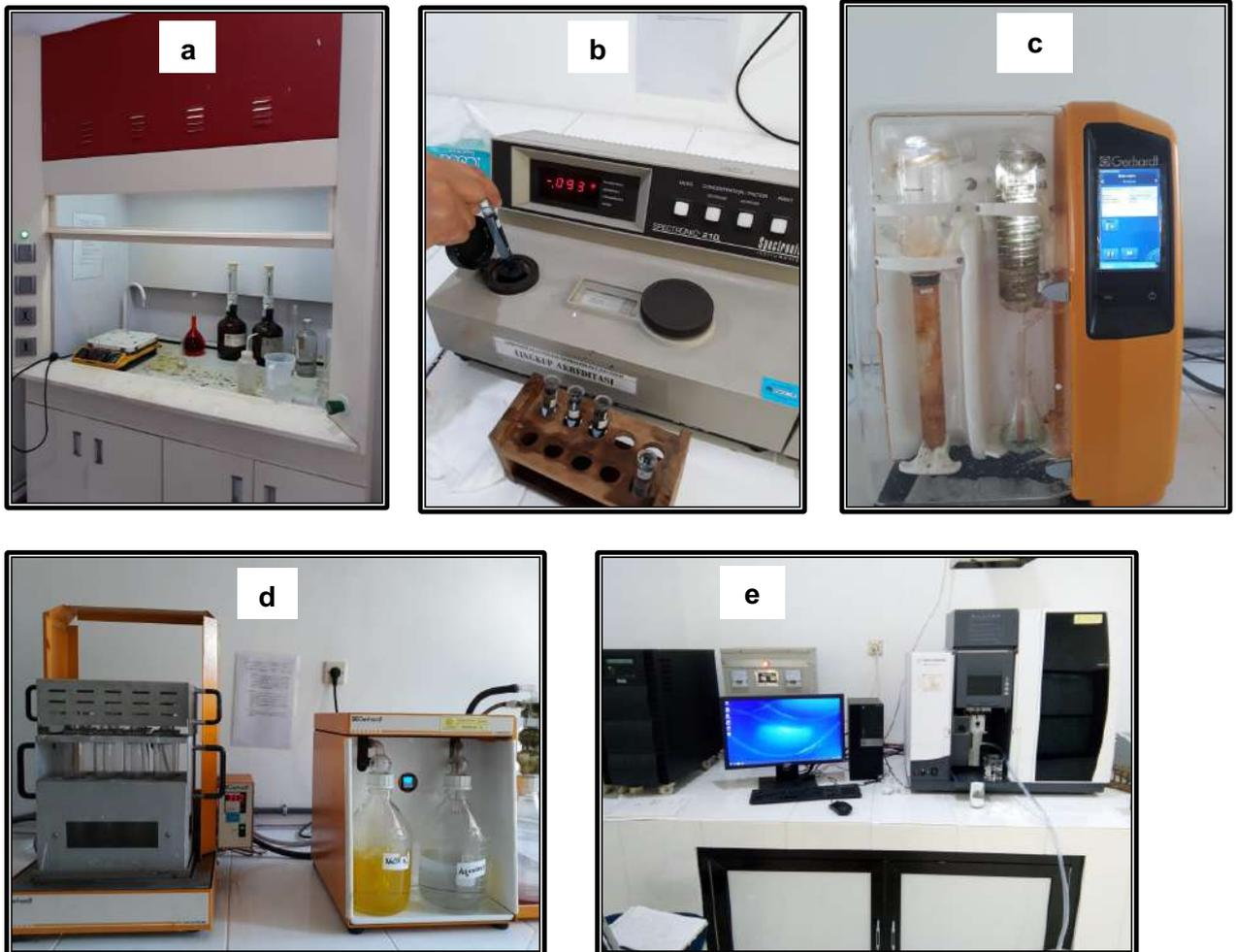
**Gambar 23.** Peralatan di laboratorium BPTP Jawa Tengah yaitu: a. Almari Asam; b. Spektrofotometer; c. Alat Destilasi; d. Alat Destruksi dan e. AAS
